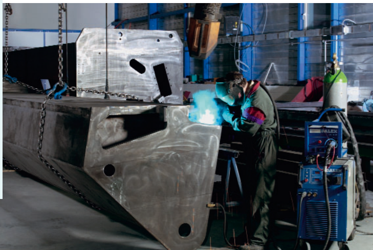
Montage- und Schweissarbeiten an grosskalibrigen Maschinen-Bauteilen.
