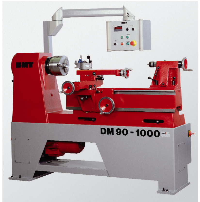
Drehmaschine DM 90-1000 Drehdurchmesser = 900 mm, Drehlänge = 1000 mm
